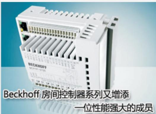
BC9191-0100内存为128kbyte, 与BC9191-0000相比, BC9191-0100的内存更大。这让用户能够创建更复杂的用户程序, 包括使用针对ModbusRTU或TwinCAT串口通讯的软件库。与房间控制单元之间的通讯主要通过ModbusRTU协议实现。然而, 具有可自定义的串口通讯设备, 如房间控制单元或气象站, 可通过RS485接口连接。
