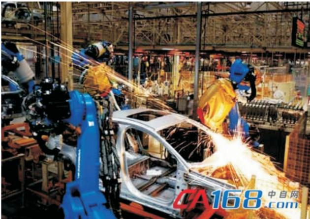
性的生产线。柔性最大的特点就是一套工装能够实现不同件的生产,这一个上面可以放四到五套夹具,自动来回旋转切换焊不同的零件,不同的点能够抓取不同的焊枪。智能化就是根据工件特殊的材质特殊的要求能自动选择焊接参数,以前只能焊一种钢,现在能焊好多种
