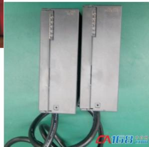
近日，工业自动化领域领先的产品与服务提供商亿维(UniMAT)正式发布了YW365机架扩展模块，订货号为：UN365-0BA01-0AA0，这是一款通讯接口模块，包括两个模块，一个用于主机架，一个用于扩展机架，包含连接电缆。无需单独供电，支持CPU313C及以上的S7-300系列CPU。
