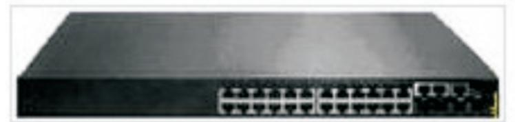
讯展S3600系列交换机基于新一代BROADCOM高性能交换机IC，开发的运营级千兆三层网管交换机，产品符合讯展QUICVIEW集群管理平台，可为用户提供丰富灵活的业务特性，有效地提高产品可运营、可管理和业务扩展能力，具备优异的防雷能力和安全特性。产品可全线速转发IPv4/IPv6的2/3层数据包；该产品支持丰富的路由功能，可支持静态、RIP、OSPF等路由协议，且支持IPv6版本的RIPng，OSPFv3等动态路由协议。产品同时支持强大的ACL功能；支持QINQ，满足VLAN灵活部署的需求；产品具有SNMP、WEB、TELENET、CLI等丰富的管理方式；同时具备QOS、RSTP\MSTP、IGMP等功能；防ARP、RADIUS认证、802.1X认证等功能，让网络更加安全。
