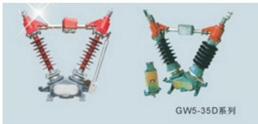
GW5系列户外隔离开关是双柱水平回转式结构，每极两个绝缘支柱带着导电闸刀反向回转90°，形成一个水平断口。两个支柱呈V型交角50°，安装在一个底座上，安装灵活方便。按接地方式可分为：不接地、单接地、双接地。隔离开关与接地开关之间设有机械连锁。接线端通过软连接过渡，导电可靠，维修方便，触头元件用久后可更换新件，保养容易。
