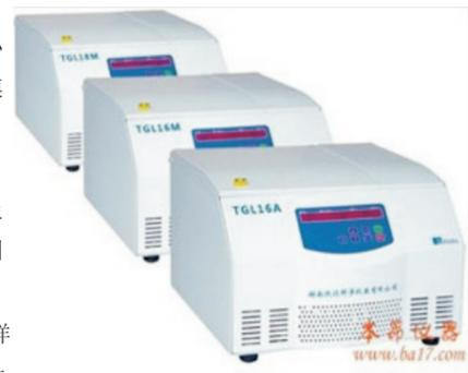
微机控制，数字显示，触摸面板，可编程操作，无刷电机，RCF值可自动计算，设有电子门锁、超速等多种保护及参数自动记忆功能，可以适配多种转子，采用进口压缩机组，可实现-20℃~40℃之间的温度控制。
