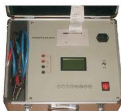
内阻与容量的相关性是：当电池的内阻大于初始值(基值)的25%时，电池将无法通过容量测试。当电池的内阻大于初始值的2倍时，电池的容量将在其额定容量的80%以下。本系列蓄电池内阻测试仪是快速准确测量蓄电池内阻的最新测试仪器，采用异频信号测试法，彻底解决了测试过程中的工频干扰；采用高精度数字选频、高精度采样A/D、DDS、梳状滤波等新技术确保了测试精度。该仪表能对蓄电池进行离线/在线测试(断开充电器
