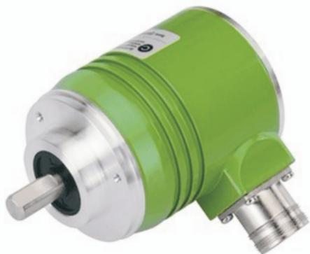
产品说明：模拟量4...20mA绝对值多圈编码器EAMS58系列，结构紧凑，具有良好的抗机械损伤性能，能够承受较高的轴向和径向负载。机械上标准欧标法兰，方便客户现场安装。EAMS58系列编码器可提供整体16位数据输出，采用模拟量4...20mA输出，满足特殊上位机接口需求，单圈分辨率与圈数可选用不同组合，满足各类现场应用需求。
