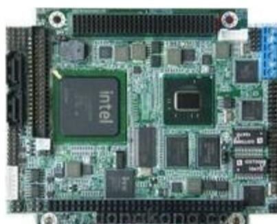
嵌入式工业计算机领导厂商——磐仪科技推出了采用Intel® Atom™ N455处理器的PC/104-Plus模块Em104P-i2909。
