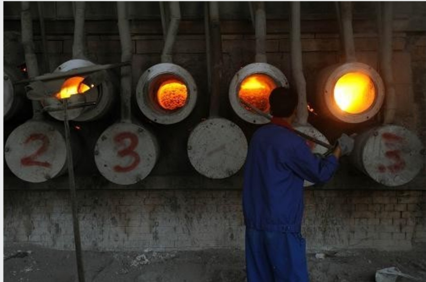
山西省运城市金星镁业有限公司内，一名工人正在向天然气回转窑内添加镁铁矿。据该企业介绍，使用天然气回转窑后，能耗从原来的每吨金属镁需9吨标准煤下降到现在的折合约4吨标准煤。
